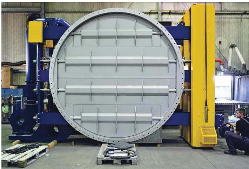
Doppelabsperklappe NW 3150 mit Sperrgasgebläse und pneumatischen Anschlüssen
