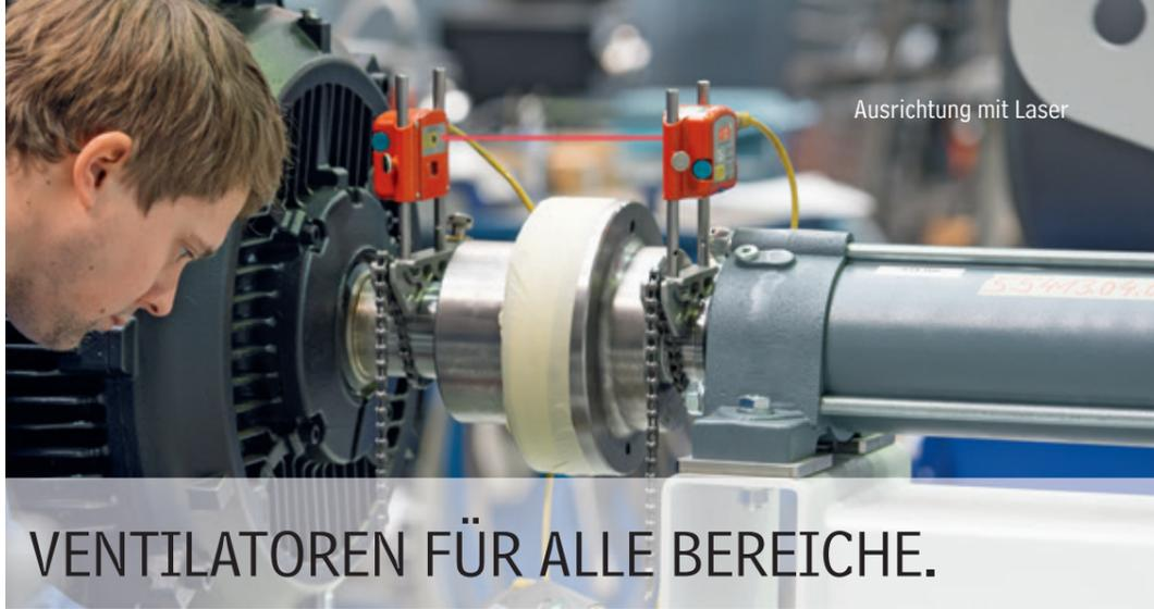
Ausrichtung mit Laser
